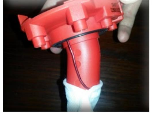
Foto 6 e 7 - Allineare la parte curva del filtro verso la parte bassa del serbatoio e calzare il filtro sul collo del bocchettone.allargare o stringere leggermente il foro in modo che aderisca bene al collo.
