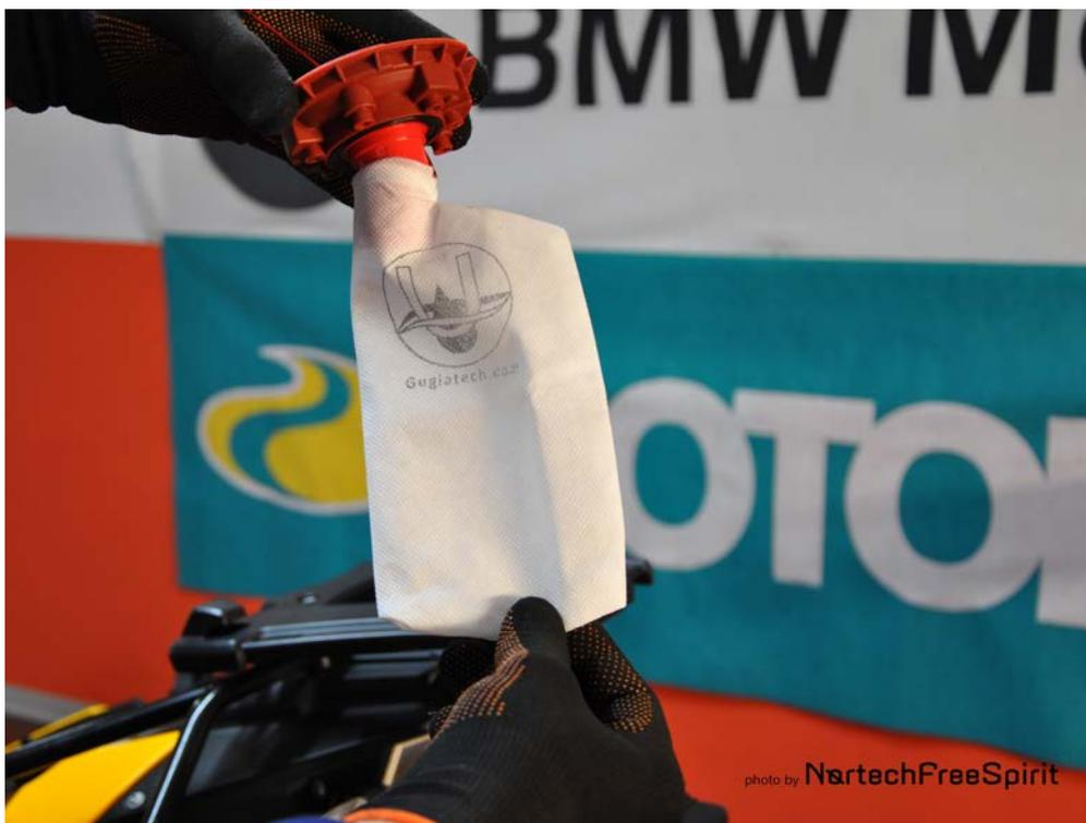
Foto 9: calzare il filtro per circa 20mm dalla parte inferiore, a questo punto far aderire bene al collo del bocchettone sia il filtro che l'astina in alluminio
