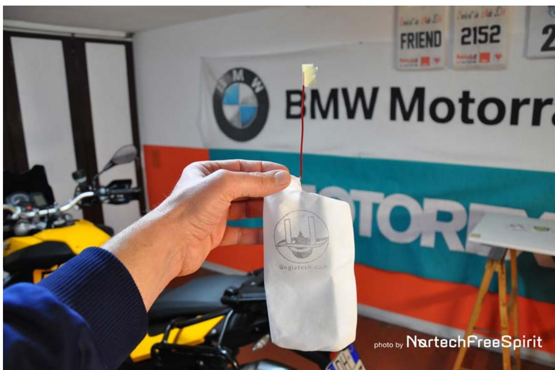
Foto 3: allineare l'astina di fissaggio in alluminio al filtro di 90° sul foro di applicazione.
