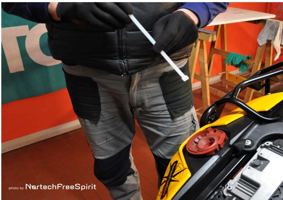
Foto 13: prendere la fascetta di plastica in dotazione nel kit di montaggio, ed inserirla nel bocchettone dalla parte della testina.
