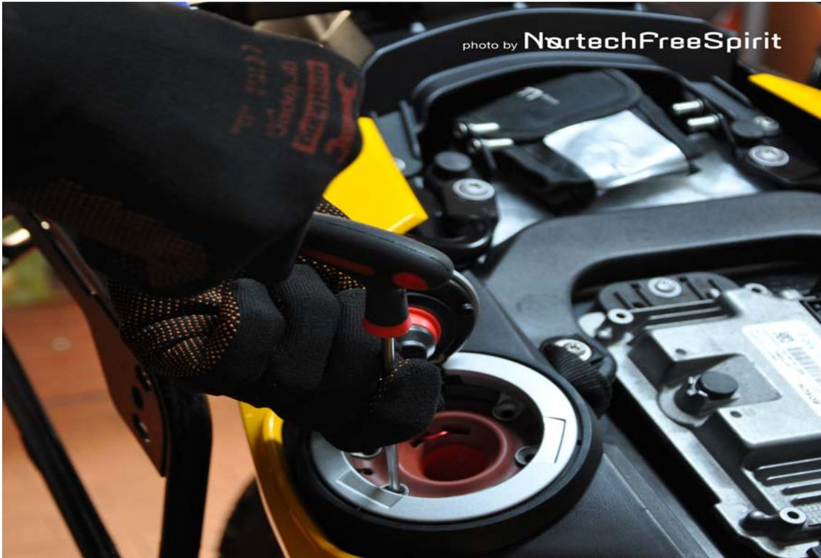
Foto 15: riavvitare il bocchettone, posizionare il tappo di chiusura e riavvitare anch'esso.
