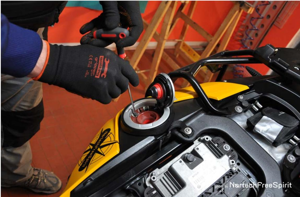
Foto 5: rimozione del tappo di chiusura del bocchettone, n° 4 vita torx da 30mm.
