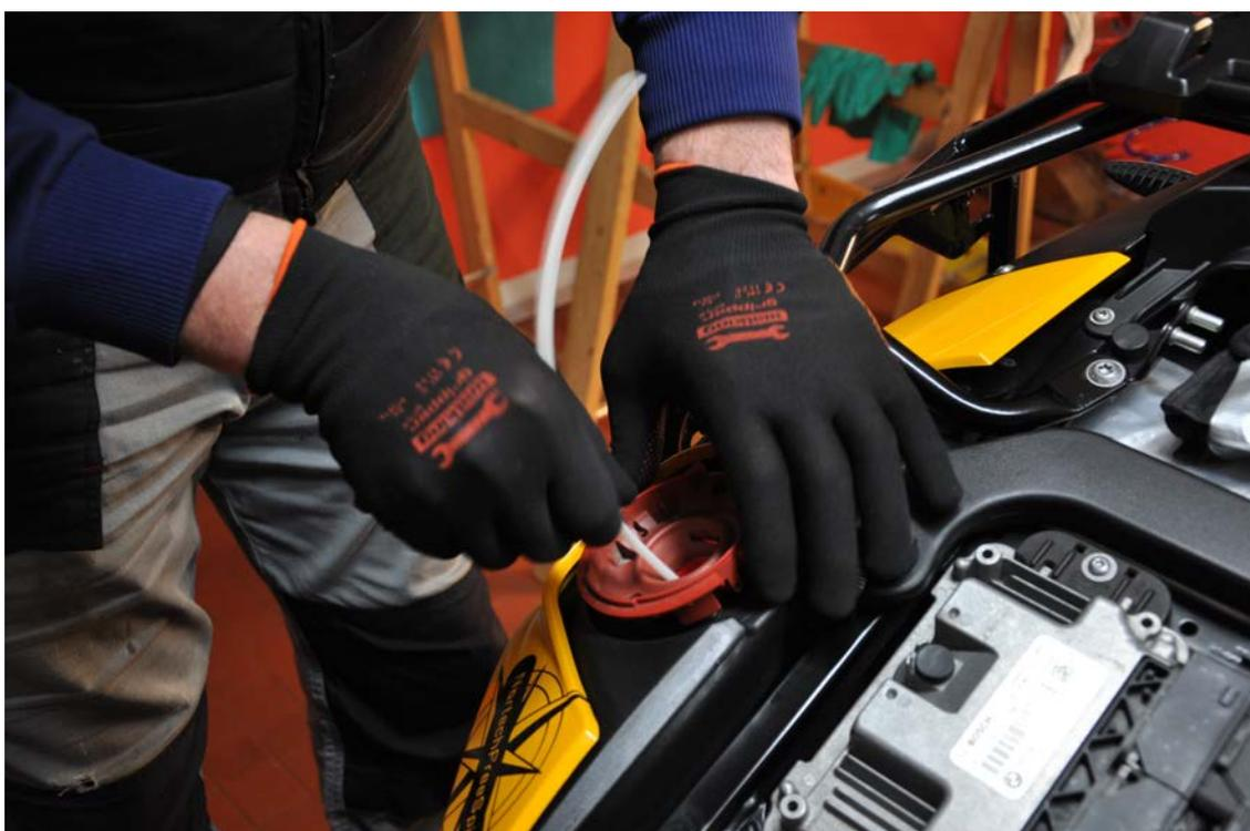
Foto 14: ora verificare che il filtro sia ben disteso all'interno del serbatoio, facendo scorrere la fascetta negli angoli.
