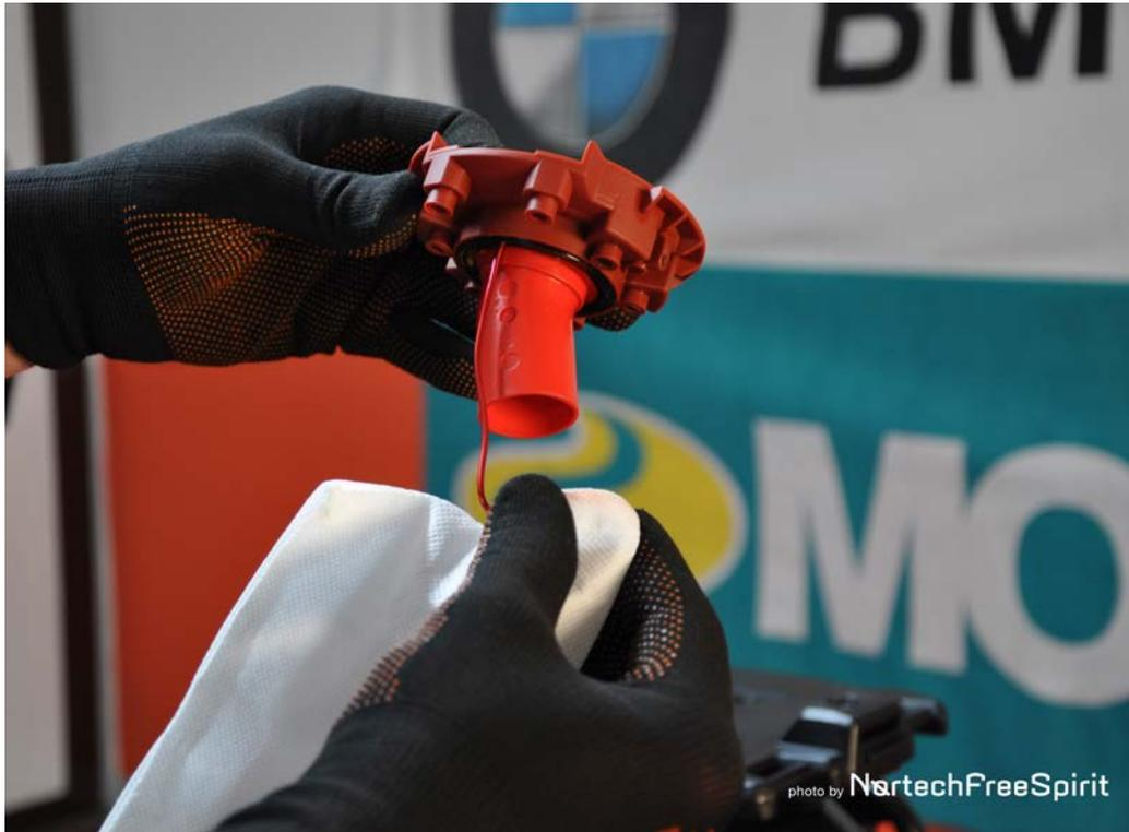
Foto 8: calzare il filtro sul collo del bocchettone e far passare l'astina di fissaggio nella feritoia superiore.
