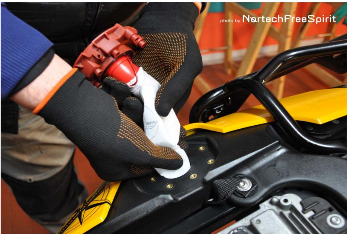
Foto 12: a questo punto inserire il filtro con il bocchettone nel foro del serbatoio, facendo attenzione di non attorcigliare troppo il filtro.
