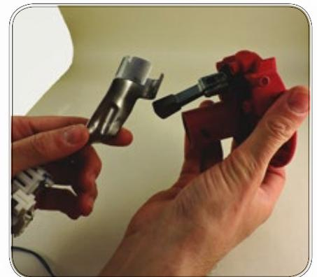
Stringete la "C" della flangia per ripristinare la corretta pressione per il rimontaggio sulla bocchetta.
