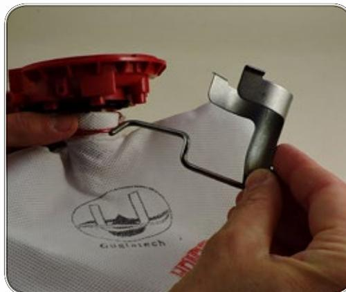
Prima di rimontare il filtro, inserire la flangia porta sensore fino in cima, inserire quindi il filitor e chiudere usando il filo rosso..
