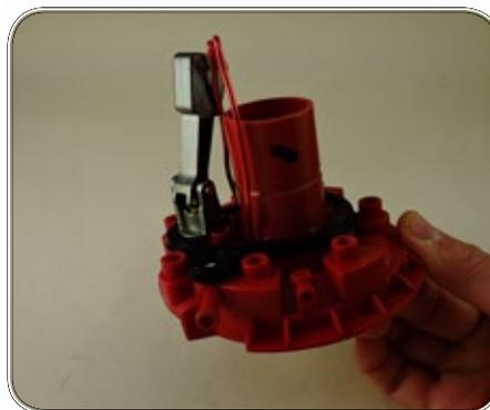
Infilate le estremita' quindi nelle apposite feritoie del filtro e montate quindi il filtro sul collare della bocchetta rossa chiudendo poi il filo attorno al collo, filtro montato.
